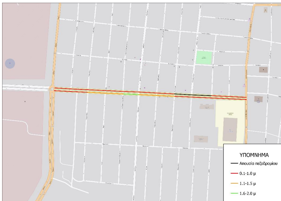
Εικόνα 39: Πλάτος πεζοδρομίου πόλης Ξάνθης – Οδός Περικλέους
